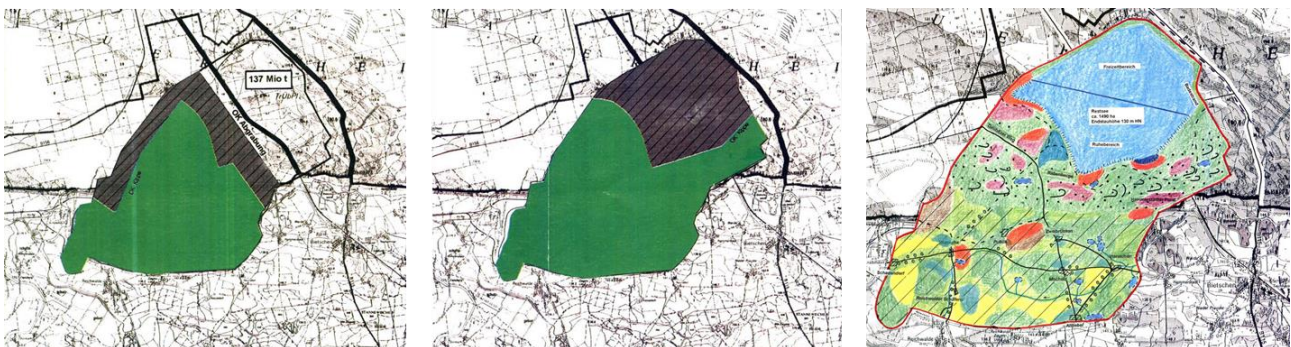
Abbildung 99: Abbaustände im Tagebau Reichwalde laut BKP Nach Auskohlung von Süd- und Nordfeld (links) und nach Auskohlung des Nordostfeldes und damit des gesamten Tagebaus laut BKP (Mitte); Grün: Kippenfläche, Schraffur: offener Tagebaubereich. Rechts Bergbaufolgelandschaft mit Restsee von rund 1.500 ha. 249
