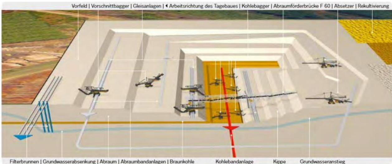
Abbildung 43: Arbeitsprinzip Tagebau Welzow-Süd TA I, Südfeld 111
