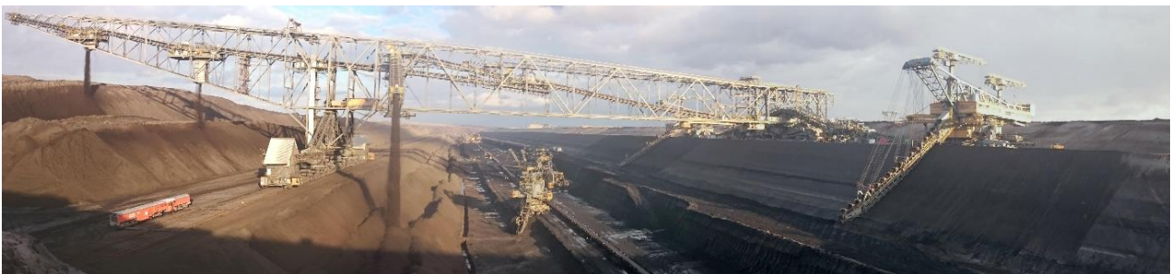
Abbildung 44: Panorama Tagebau Welzow-Süd Februar 2016 Rechts Abraumförderbrücke mit zwei Eimerkettenbaggern im Tiefschnitt. Mittig Grubenbetrieb mit Kohleförderband und Eimerkettenbagger im Vordergrund. Links Abraumkippe mit kippenseitiger Gleisanlage und Abraumverkipfung auf drei Ebenen. 112
