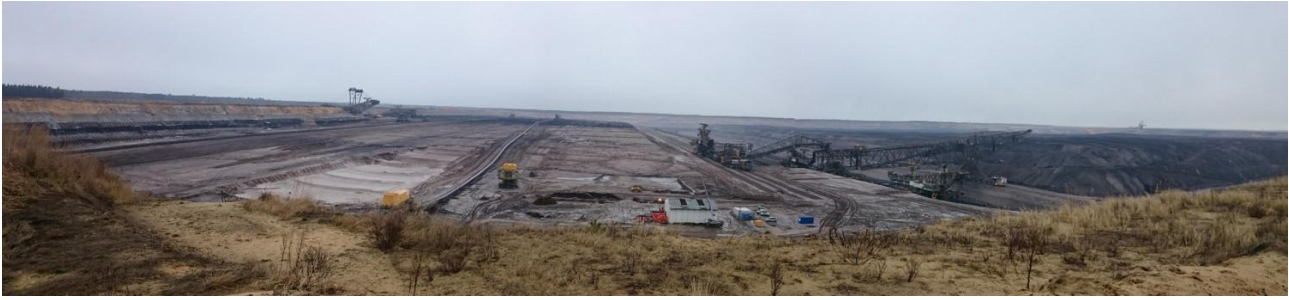
Abbildung 25: Panorama Tagebau Nochten, Südwestende der Abbaustrosse Rechts Abraumförderbrücke mit vorgelagertem Kippenfeld. Links ausgekohelter Bereich des Oberflözes 65
