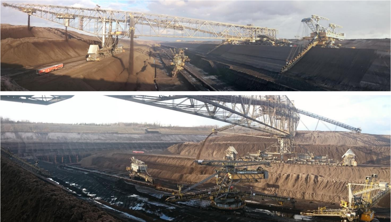
Abbildung 15: Panoramen Tagebau Welzow-Süd mit aktivem Abbaubereich Oben rechts Anschnitt miozäner Ablagerungen mit horizontaler Lagerung und schwarzen Kohleflözen. Darunter Kohleabbautrossen mit Kohlentransportbandanlage. Abraumverkipfung durch Abraumförderbrücke. 25
