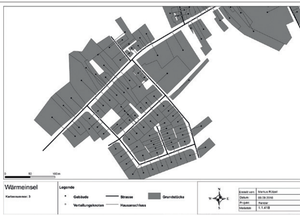
Abb. 2: Geoinformations-gestützte Trassierung einer Nahwärmeleitung
