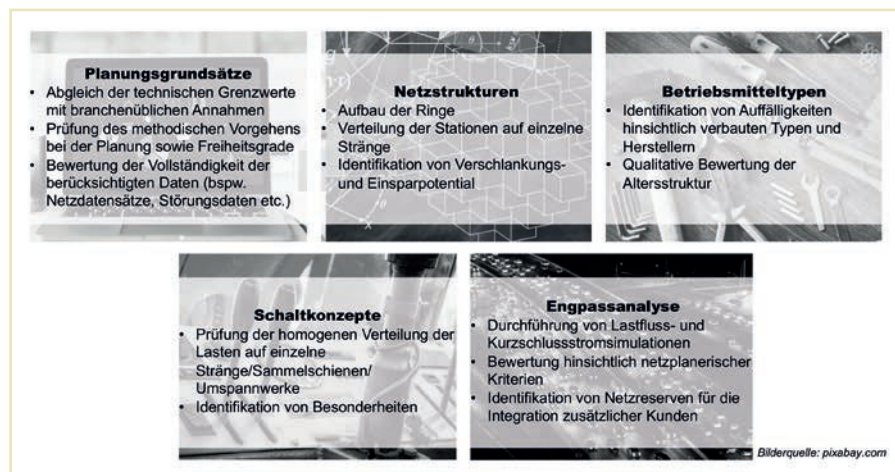
Abb. 1 Analysen des Bestandsnetzes als Basis für die Zielnetzplanung
